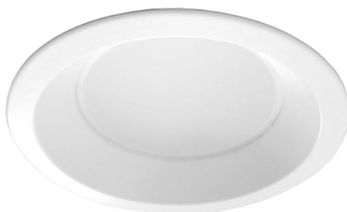
LED Einbauleuchte, Lichtverteilung symmetrisch, Gehäuse aus Aluminium, Reflektor weiß mit zurückversetzter opalen Abdeckung PMMA, Passive Kühlung aus Aluminium, Treiber nicht dimmbar separat mit Verbindungsleitung, Farbe weiß RAL 9016
