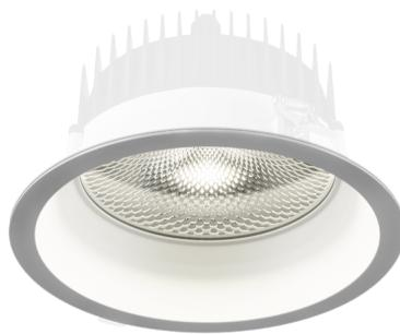
LED Einbauleuchte, Lichtverteilung symmetrisch, Einbauring aus Aluminium-Druckguss pulverbeschichtet, Reflektor aus 99,9% Reinstaluminium facettiert UGR<16, Sicherheitsglasscheibe klar, Passive Kühlung aus Aluminium, Multi-Treiber nicht dimmbar separat mit Verbindungsleitung, Werkzeugloser Einbau durch Klappfeder, Farbe weiß RAL 9016
