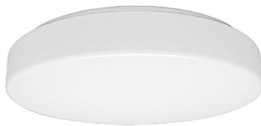
LED Anbauleuchte mit zylindrischer opaler Wanne aus PMMA seidenmatt, Lichtverteilung symmetrisch, direkt 85%/indirekt 15%, Gehäuse aus Stahlblech pulverbeschichtet, Passive Kühlung, Treiber nicht dimmbar im Gehäuse integriert und einstellbar 8-fach (16-fach bei 1100-3500lm) über DIP-Schalter, Schlagschutz IK02, Farbe weiß RAL 9016
