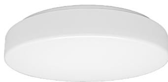
LED Anbauleuchte mit zylindrischer opaler Wanne aus PMMA seidenmatt, Lichtverteilung symmetrisch, direkt 85%/indirekt 15%, Gehäuse aus Stahlblech pulverbeschichtet, Passive Kühlung, Treiber nicht dimmbar im Gehäuse integriert und 4-fach (15-fach bei 1300-2300lm) einstellbar über DIP-Schalter, Schlagschutz IK02, Farbe weiß RAL 9016
