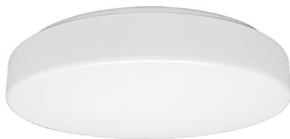
LED Anbauleuchte mit zylindrischer opaler Wanne aus PMMA seidenmatt, Lichtverteilung symmetrisch, direkt 82%/indirekt 18%, Gehäuse aus Stahlblech pulverbeschichtet, Passive Kühlung, Treiber nicht dimmbar im Gehäuse integriert und 22-fach einstellbar (13-fach bei 2000-5700lm) über DIP-Schalter, Schlagschutz IK02, Farbe weiß RAL 9016
