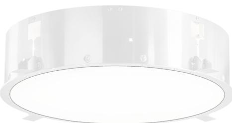
LED Einbauleuchte rahmenlos, geeignet zum Einbau in Gipskartondecken bis zu 30mm, Lichtverteilung symmetrisch, Einbauring und Gehäuse aus Aluminium, mit microprismatischer Abdeckung UGR<19, Passive Kühlung aus Aluminium, Treiber nicht dimmbar im Gehäuse integriert, incl. Lochblech-Montagewinkel, Farbe weiß RAL 9016
