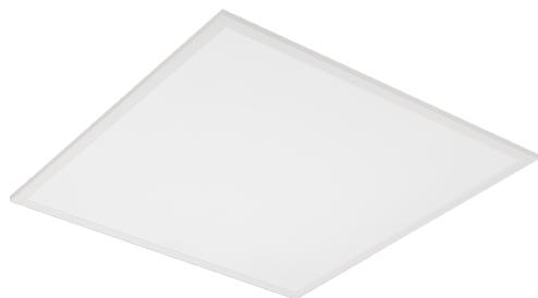
LED Einlegeleuchte, Modul 625, Lichtverteilung symmetrisch, Rahmen aus Aluminium pulverbeschichtet, mit microprismatischer Abdeckung (UGR<19 bei 30W 5000lm), Passive Kühlung aus Aluminium, Treiber nicht dimmbar separat mit Verbindungsleitung, Farbe weiß RAL 9016
