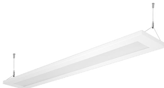
LED Ring-Pendelleuchte, Lichtverteilung symmetrisch, direkt/indirekt, Gehäuse aus stranggepresstem Aluminium pulverbeschichtet, Passive Kühlung aus Aluminium, mit opaler Abdeckung, Treiber nicht dimmbar im Gehäuse integriert, 3-fach/4-fach Seilabhängung 2000mm und Kabel transparent, Baldachin, Farbe weiß RAL 9016
