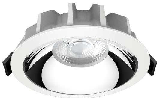
LED Einbauleuchte, starr, Lichtverteilung symmetrisch, Einbauring und Gehäuse aus Aluminium, pulverbeschichtet, Passive Kühlung aus Aluminium, Reflektor silber aus 99,9% Reinstaluminium und Linse 36°, Treiber nicht dimmbar separat mit Zugentlastung, Werkzeugloser Einbau mit Klappfedern, Farbe weiß RAL 9016
