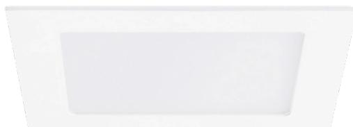
LED Einbauleuchte, Lichtverteilung symmetrisch, Einbaurahmen und Gehäuse aus Aluminium pulverbeschichtet, Passive Kühlung aus Aluminium, mit innenliegender opaler Abdeckung, Treiber Dali dimmbar separat mit Verbindungsleitung, Werkzeugloser Einbau mit Klappfedern, Farbe weiß RAL 9016
