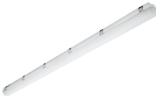
LED Feuchtraumwannenleuchte, Lichtverteilung symmetrisch, direkt, Gehäuse aus Polycarbonat grau, Passive Kühlung, opale Polycarbonatabdeckung, INOX-Verschlüsse, Treiber nicht dimmbar mit DIP-Schalter (4 Leistungsstufen) im Gehäuse integriert, Vorbereitet für die Durchgangsverdrahtung (Eingang PG-Verschraubung, Ausgang Doppelmembran-Stutzen)
