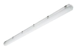
LED Feuchtraumwannenleuchte, Lichtverteilung symmetrisch, direkt, Gehäuse aus Polycarbonat grau, Passive Kühlung, opale Polycarbonatabdeckung, INOX-Verschlüsse, Treiber nicht dimmbar mit DIP-Schalter (4 Leistungsstufen) im Gehäuse integriert, Schlagschutz IKO8, Vorbereitet für die Durchgangsverdrahtung (Eingang PG-Verschraubung, Ausgang Doppelmebran-Stutzen)
