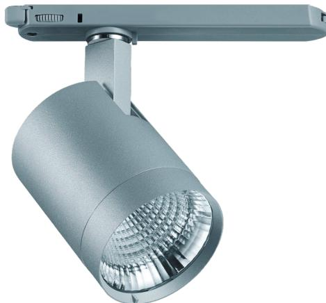
LED Stromschielenstrahler, 350° dreh- und 90° schwenkbar, mit 3-Phasen-Intrackadapter und integriertem Treiber, nicht dimmbar, Gehäuse aus Aluminium-Druckguß, pulverbeschichtet, Hocheffizienter Reflektor aus 99,9% Reinstaluminium, silber eloxiert 36°, Bajonettfrontring mit klarem Schutzglas für werkzeuglosen Reflektorwechsel (das Schutzglas schützt Chip und Reflektor vor Verunreinigungen), Passive Kühlung, Farbe weiß RAL 9016 Feinstruktur
