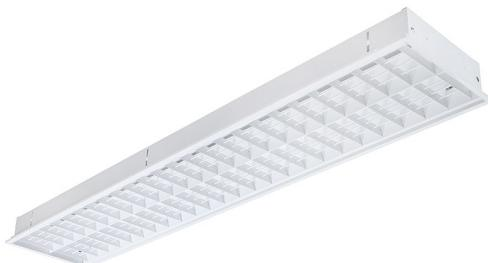
LED Einbauleuchte ballwurfsicher, symmetrisch, direkt, Gehäuse aus Stahlblech pulverbeschichtet, Stahlblechraster weiss mit hinterlegter Opaler Abdeckung, verschraubt und verstärkt, Treiber nicht dimmbar im Gehäuse integriert, incl. Befestigungssatz, Farbe weiß RAL 9003
