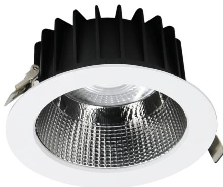
LED Einbauleuchte, Lichtverteilung symmetrisch, Einbauring aus Aluminium-Druckguss pulverbeschichtet, Reflektor 36° tief-/breitstrahlend aus 99,9% Reinstaluminium hochglänzend facettiert (UGR<19 bis 20W/2700lm) mit Linsenoptik für eine bessere Lichtverteilung, Passive Kühlung aus Aluminium, Multi-Treiber nicht dimmbar mit DIP-Schalter (5 Leistungsstufen) separat mit Verbindungsleitung, Werkzeugloser Einbau durch Klappfeder, Farbe weiß RAL 9016
