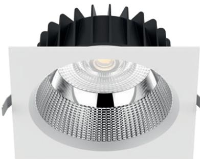
LED Einbauleuchte quadratisch, Lichtverteilung symmetrisch, Einbauring aus Aluminium-Druckguss pulverbeschichtet, Reflektor 36° tief-/breitstrahlend aus 99,9% Reinstaluminium hochglänzend facettiert (UGR<19 bis 20W/2700lm) mit Linsenoptik für eine bessere Lichtverteilung, Passive Kühlung aus Aluminium, Multi-Treiber nicht dimmbar mit DIP-Schalter (5 Leistungsstufen) separat mit Verbindungsleitung, Werkzeugloser Einbau durch Klappfeder, Farbe weiß RAL 9016
